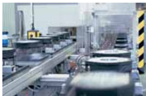
Links: flexibles Montagesystem, Kapazität 1.000 Bremsen im Variantenmix pro Schicht.
